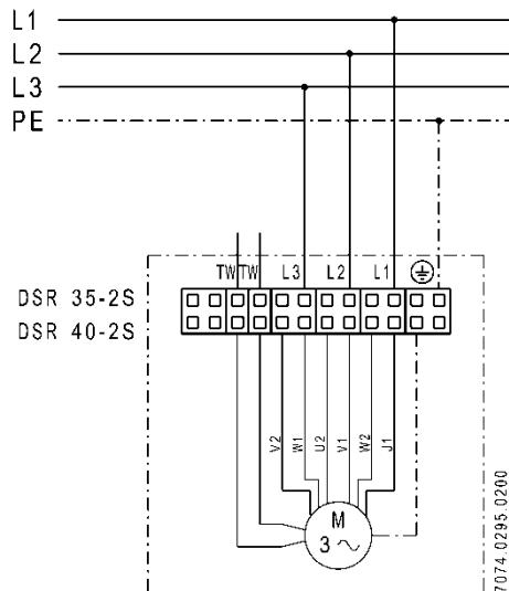
TW = Steuerstromkreis / Control circuit / Circuit de commande
